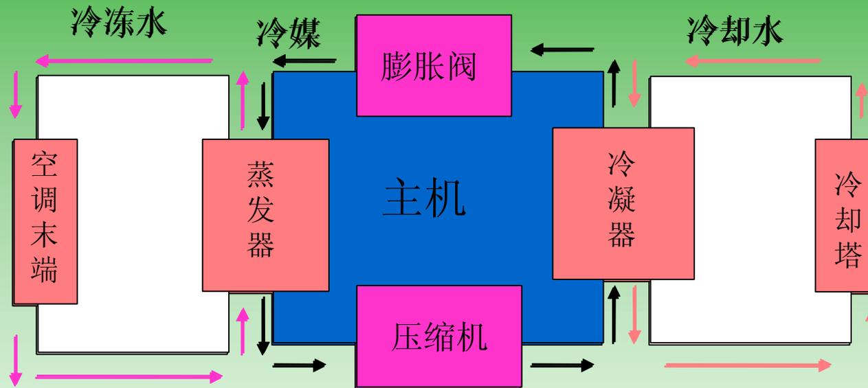
空调制冷系统流程示意图
